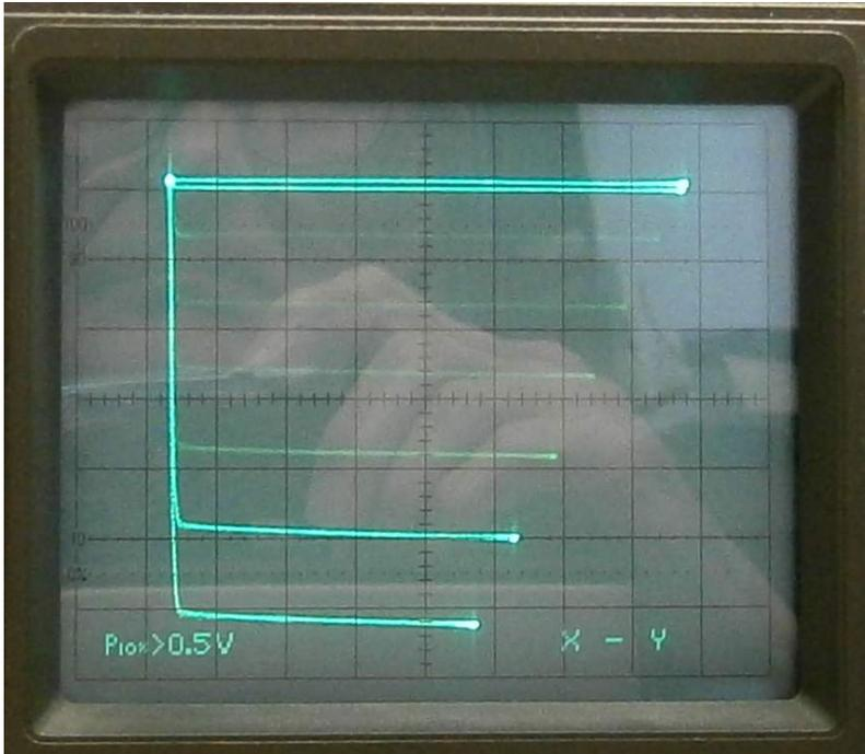
Oszilloskop als Sichtgerät des Kennlinienschreibers zeigt unpassendes und unstetes Bild.
