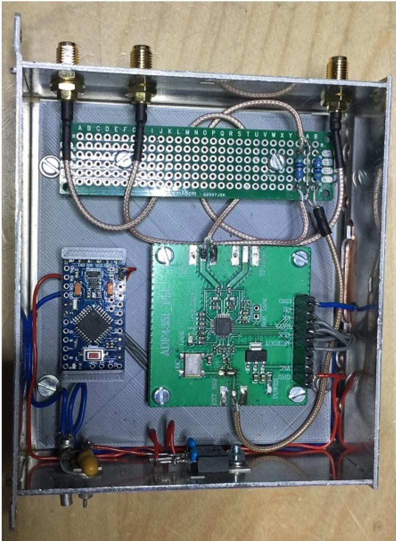
Die Frequenzstabilität spielt bei einer QO100 TRX Anlage, selbst bei SSB, eine große Rolle. Weder die verwendeten SAT-LNBs noch die meisten SDRs verfügen über eine wirklich ausreichende Frequenzstabilität die über ein QSO hinausgeht ... . Wie sich das ändern läßt, zeigt Reinhold, OE5RNL, in seinem Bericht. Arduino-SourceCode (adf4153-qo100-v1.ino) (/sites/oevsv/technik-folder/J2019/bin/adf4153-qo100-v1.ino) mit rechter Maus-Taste speichern.
