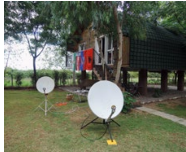
Sende- und Empfangsspiegel für DATV
