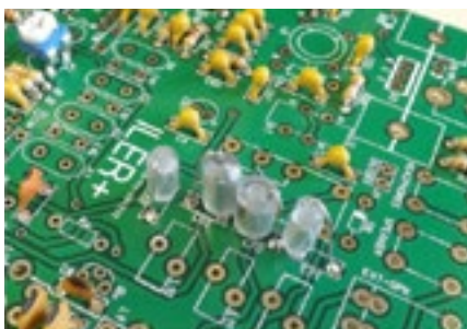
Montage der Polystyrol-Kondensatoren Quelle: Bauanleitung ILER-40
