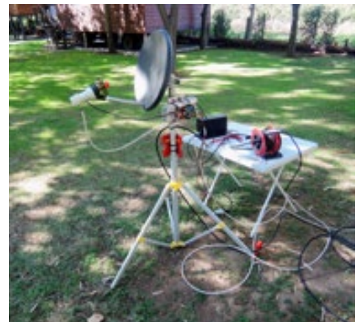
Sende- und Empfangsspiegel für DATV
