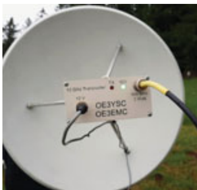
60 cm Parabolspiegel mit Transverter, die PTT wird mittels 12V Spannung am Koaxkabel geschaltet
