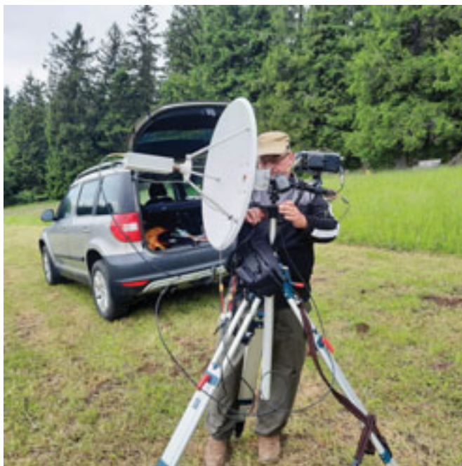
3 cm portable Equipment, drehbar, IC 705, 3cm-Transverter Kuhne mit Preamplifier, 2W PA-Modul und Mini-Relais mit Feedantenne
