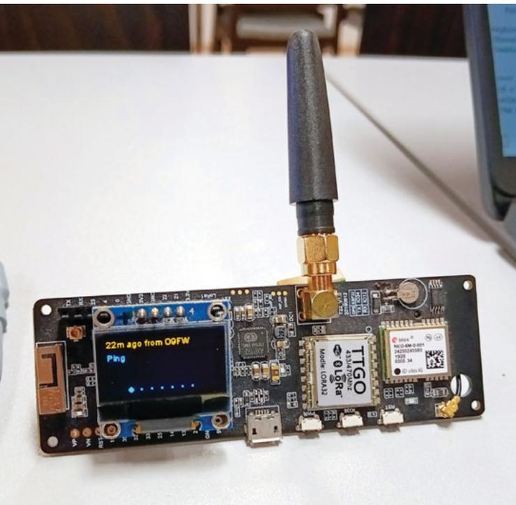
Meshtastic-Knoten (TTGO T-Beam) von OE9TKH mit Testnachricht Foto: OE9LTX
