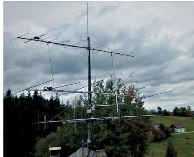
Sonntagvormittag war die Tropo besonders gut ausgeprägt, einige Stationen aus OE konnten sogar in SSB und auf dem 70cm-Band DX-Verbindungen herstellen. Ich benutze für 2m DX einen IC-7100 mit einer 300W PA und eine 13 Element Crushraft Yagi-Antenne.
