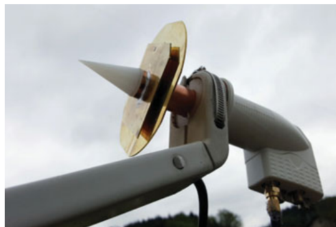
oben: hier wurde das Wetterschutzgehäuse teilw. belassen und das Feedhorn entfernt, um das Kupferrohr mit Kegelvorsatz und die 13 cm TX-Antenne aufzusetzen.
