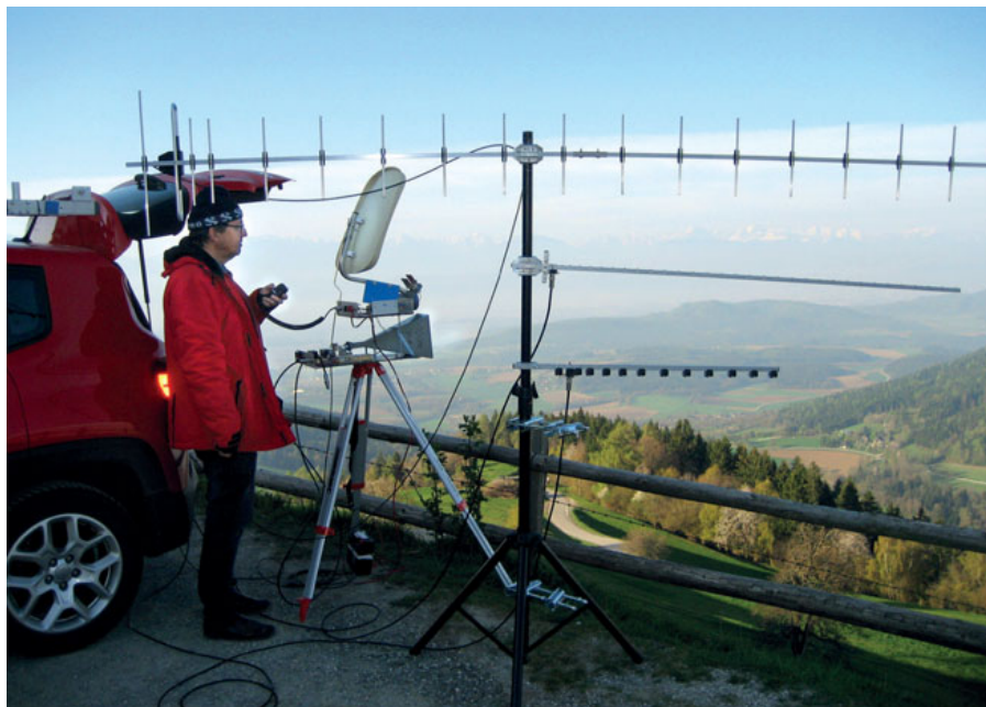
Erwin OE8EGK am 21. April 2019 am Magdalensberg, JN76FR. Zu sehen sind die Antenne bzw. Geräte für die Bänder 432 MHz, 1296 MHz, 2320 MHz, 3401 MHz, 5760 MHz und 10368 MHz.
