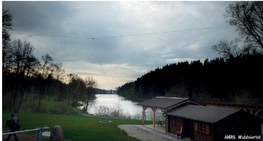
Aufgebaut wurde ein selbst gebauter Dipol für das 80m Band, der zwischen zwei Bäumen in ca. 15m Höhe aufgehängt wurde
