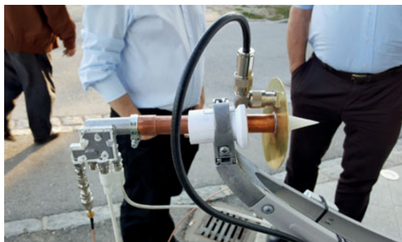
oben: Kombi LNB-Antenne 10GHz (RX) /2400 MHz (TX) rechts: Rückseite der Kombiantenne
