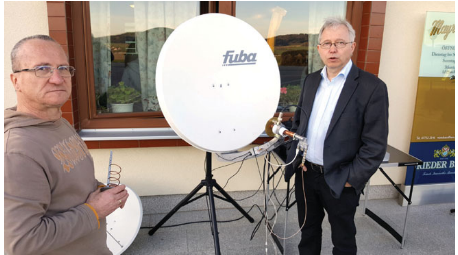
OE5RNL (rechts) mit SAT-Spiegel und OE5SFM mit selbstgebauter 23 cm TX-Helicalantenne
