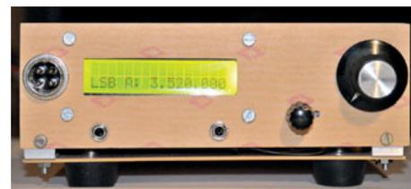
10W Allband SSB/CW Transceiver uBITX von OE6EWF im ersten Versuchsaufbau - B/H/T 165/45/160 mm
