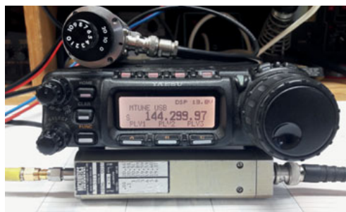
unten: Dämpfungsglied, Empfänger und Effektiv-Voltmeter Rauschgenerator
