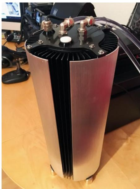
Nach Ausbau des Störfrieds (= Ventilator) aus der Endstufe und Einbau der ummantelten Röhre in die Endstufe, habe ich die Flüssigkeitsleitungen mit Rohrdurchführungen (und wieder kam die Drehbank zum Einsatz) durch die Rückwand des Gehäuses mit PVC-Leitungen bis zum Rückkühlturm geleitet. Dieser besteht aus einem gerippten Aluminiumrohr mit 90 mm Innendurchmesser. Den unteren Teil dieses Rohres habe ich mittels O-Ring abgedichtet.
