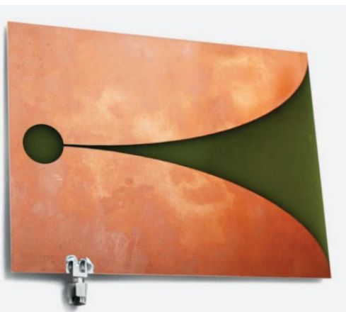
Fertige Platine mit SMA-Anschluss, Strip-Line auf der Rückseite
