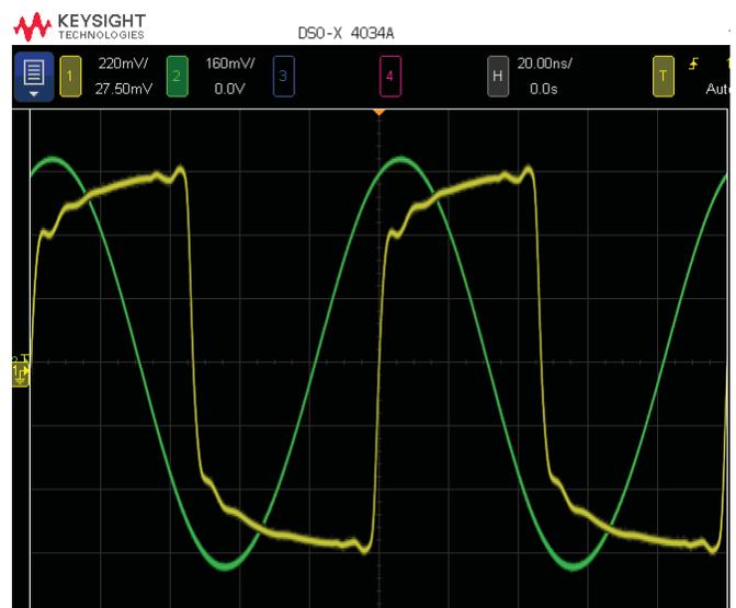
Zwei 10 MHz-Signale im Vergleich: Die gelbe Kurve stammt von einem GPDSO (GPS Disciplined Oscillator), einem mittels GPS synchronisierten Referenzsignal. Die grüne Kurve stammt vom Morion MV89. Wenn sich die grüne Kurve gegenüber der getriggerten gelben Kurve seitlich bewegt, ist eine Frequenzabweichung vorhanden. Bei 10 MHz ist auf diese Weise ein Abgleich (Stillstand der grünen Kurve einstellen) bis auf ca. +/- 5 milli-Hz sehr einfach möglich.
