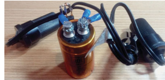
Bild 3: „Fliegender“ Aufbau der Schaltung, noch ohne Zener-Diode und Gehäuse, aber schon voll funktionstüchtig
