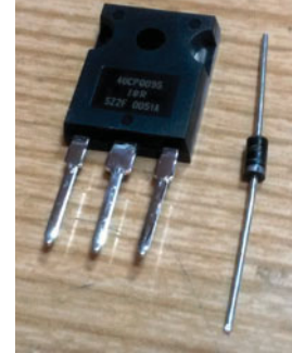
Bild 4 oben: Doppelte Zener-Diode mit gemeinsamer Kathode in der Mitte (links) und PN-Diode 1N4004 (rechts)
