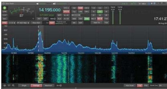
Mikrofoneingang, integrierter CW-Keyer) anbietet, können auch Softwarepakete wie Ham Radio Deluxe, SDR.com und SDRmax III mit dem ZS-400 verwendet werden. Zeus Radio wird ständig weiterentwickelt, in der aktuellen Softwareversion wurden auch Demodulatoren für BPSK und RTTY realisiert. Bis zu 96 VST-Plugins können verwendet werden. Die Software kann man kostenlos herunterladen und mit ebenfalls bereitgestellten Breitbanddateien ausgiebig testen.
