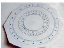
Die größere Vorlage schneiden wir mit der Schere mit Übermaß aus und kleben diese zentrisch mit UHU-Stick auf die gebrauchte CD.
