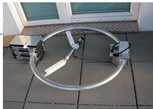
Dual-Band Log-Periodic Antenne (2 m/70 cm) und Magnetic Loop Kurzwellenantenne für Fenster oder Balkon
