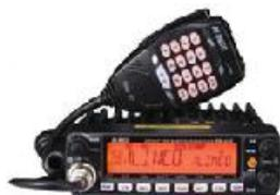
**NEU:** Alinco DR-638H Mobilfunkgerät für 2m/70cm, Duoband Vollduplex, abnehmbares Bedienteil und DTMF-Mikrofon, Sendeleistung schaltbar von 5 bis 50 Watt.
