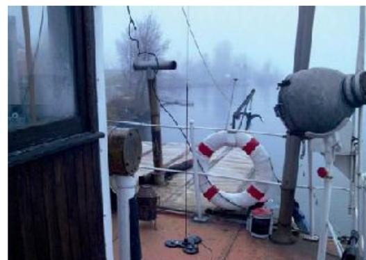
die Magnetantenne haftet an Deck
