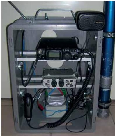
Also kaufte ich im Baumarkt eine graue Plastikbox mit den Abmessungen 40 x 30 x 22 cm wie sie in Warenlagern verwendet wird, einen Kistengriff (<http://www.lubeck-beschlaege.de/kistengriffe.php>), 2 Lochbandeisen und eine Menge Schrauben, Muttern, Karoseriescheiben und sonstige Eisenwaren.
