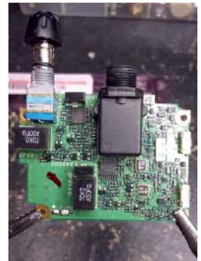
oft zeigt es sogar einen Kurzschluss. Das Problem ist bei YAESU in der Serviceabteilung bekannt und es sind ein oder zwei Stück dieser Filter in einigen Modellen dieser Handfunkgeräte eingebaut.
