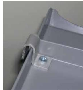
Diese Haken können an der Funkkiste eingehängt werden. Unten sind zwei Schrauben, die in Schlitze in der Funkkiste passen, die original vorhanden waren. Beim Schliessen des Deckels werden die Haken oben eingehängt und die Schrauben sichern den Deckel unten gegen seitliches Verrutschen und Aushängen der Haken.
