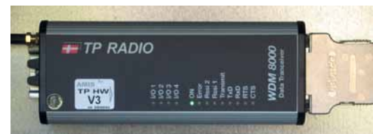
Bild 7: Foto des Funkgerätes in der Trafostation (nicht zu verwechseln mit dem AMIS-Stromzähler). Dient der Weiterleitung der Daten über Funk (70 cm-Band). Siehe dazu auch Bild 6, da ist die zugehörige Antenne zu sehen. Ab hier sind im Normalfall keine Störungen mehr zu erwarten.
