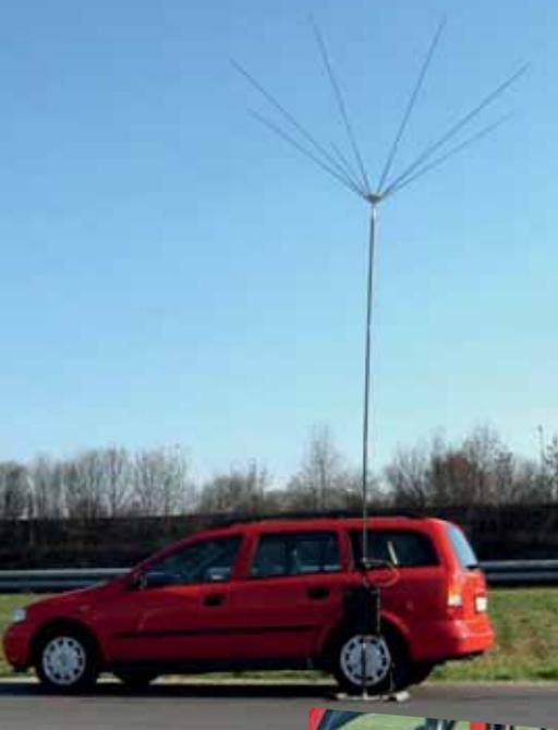
ist aber die Sternantenne gar nicht erforderlich. Der Unterteil des eigentlichen Sterns ist ein gefertigter Drehteil aus Al.
