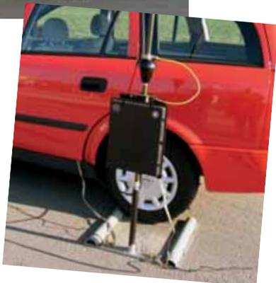
Die Sur Plus Antennenstäbe US Army AB- 22/ GR, AB- 23/ GR, AB- 24/ GR sind dort eingesteckt und mit M6 Rändelschrauben fixiert. Zwei Gegengewichte je 20 m sind auszulegen.
