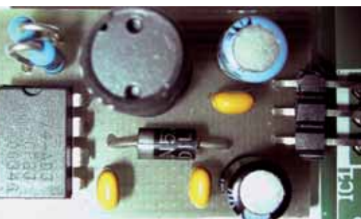
Zum Strom sparen, empfiehlt sich ein Schaltregler anstelle des 7805
