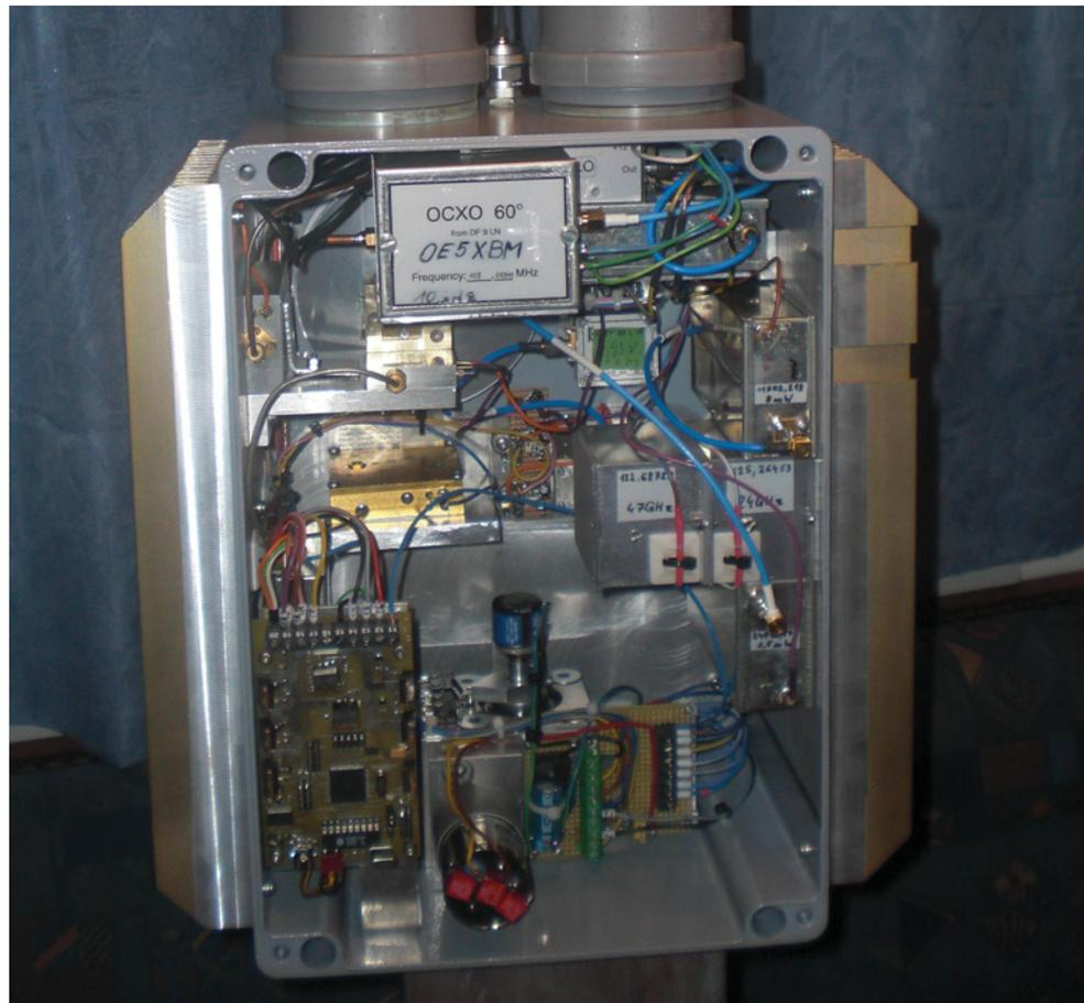
*Ansicht von der Rückseite. Innenleben: Links unten befindet sich die DTMF Steuerung mit Rufzeichengeber entwickelt und gebaut von OE5RNL. Rechts daneben sitzt der Schneckengetriebe-Rotor (12 V), darüber die Ofenoszillatoren und Vervielfacherstufen für 10 GHz, 24 GHz 47 GHz und 76 GHz und auch noch die Endstufen für 10 und 24 GHz. Oben drauf unter den Kunststoffrohren befinden sich die Hohlleiterschlitzstrahler für 10 und 24 GHz, dazwischen ist die Fernsteuerantenne.*
