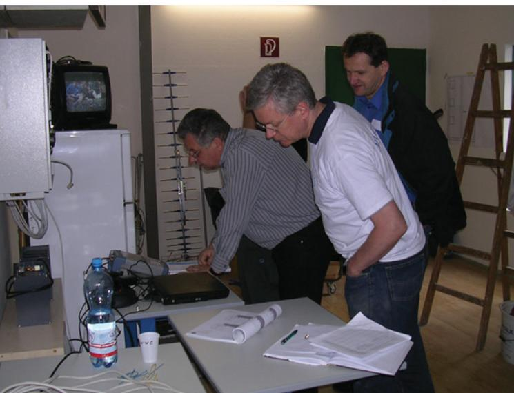
OE3DOB, OE3HBS und OE3WTB bei den umfangreichen EMV-Messungen (TV-Kontrollempfänger, Spektrumanalyzer, Messantenne, OE3XHU im Sendebetrieb) um die gegenseitige Beeinflussung zu testen.
