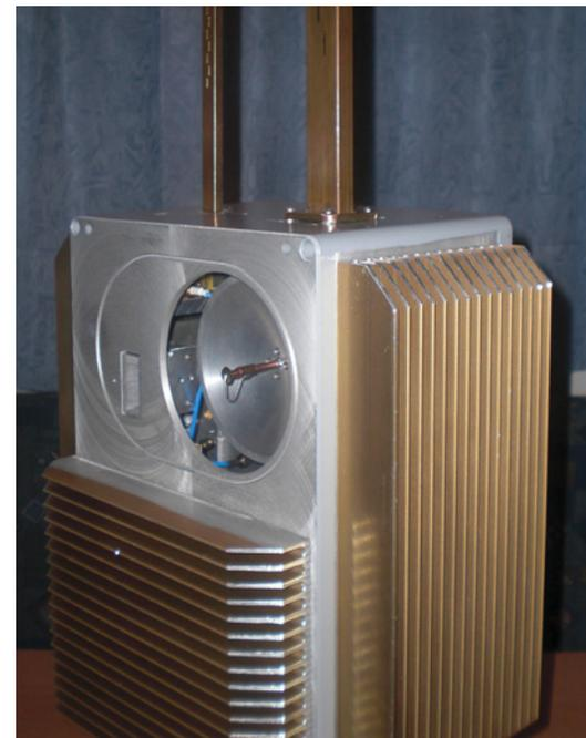
*Ansicht schräg von vorne. Die großzügig dimensionierten Kühlkörper sorgen für ausreichend Wärmeableitung. Der 10-cm-Parabolspiegel für 76 GHz und rechts daneben das Sektorhorn für 47 GHz ist deutlich zu erkennen. Rundherum erkennt man die O-Ring-Nut für die Abdichtung mit der Teflonfolie und der Blende. Obendrauf sitzen links die 24-GHz- und rechts die 10-GHz-Rundstrahlantenne.*
