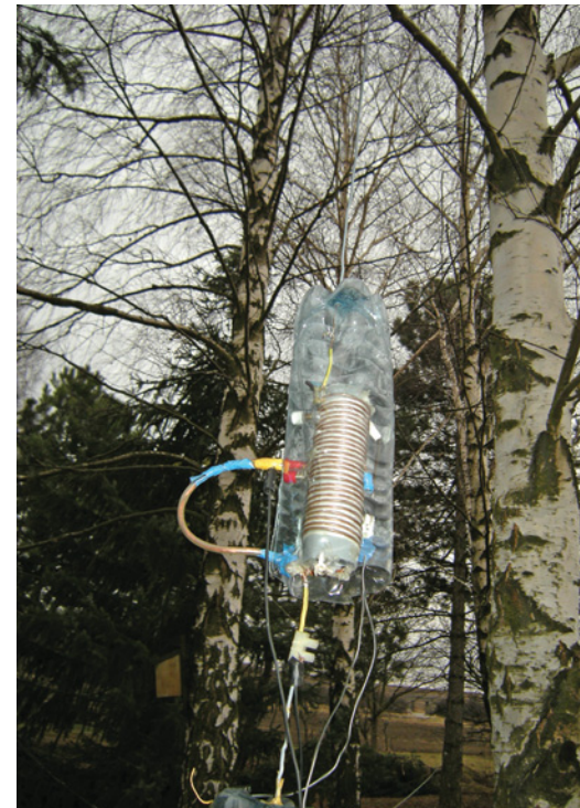
Bild 2: Obere Schutzflasche mit Spule (mit Bananensteckerabgriffen). Das Relais befindet sich parallel zur Spule und ist von dieser verdeckt.
