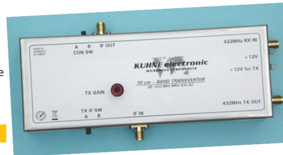
Mit diesem Modul ist es dem technisch versierten Kunden möglich, sich mit den Leistungsverstärkern MKU PA 4047-60 HY oder MKU PA 4047-120 HY einen 432-MHz-Transverter selbst zusammenzustellen.
