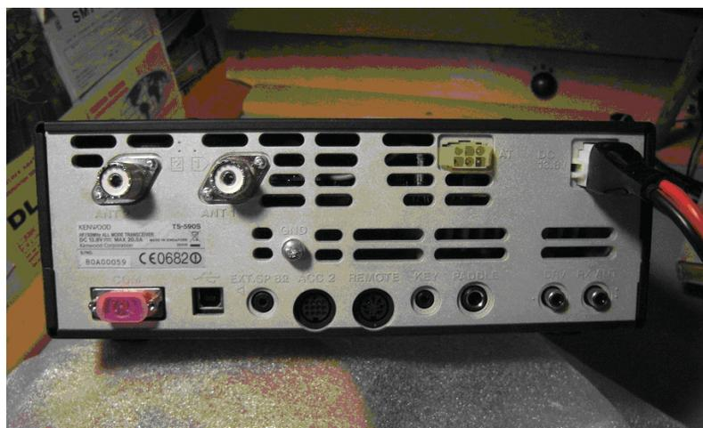
Der TS590SE – Rückansicht: Auf der rechten Seite ist der separate Eingang für Empfangsantennen zu sehen.
