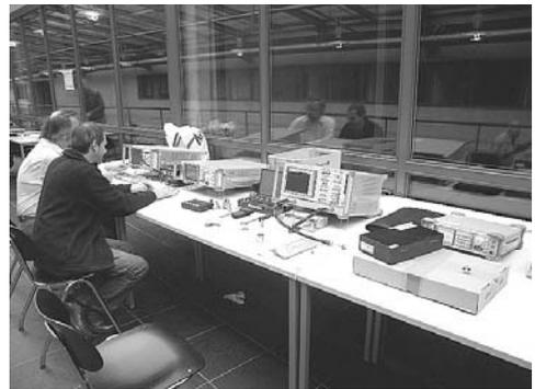
*Messgerätestand von R&S mit 26,5 GHz Spektrum Analyzer, 20 GHz Vector Network Analyzer und einem 20 GHz Messender*
