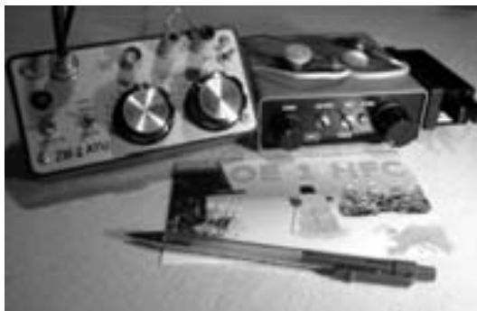
Meine Ausrüstung im HA-QRP Contest. V.l.n.r.: ZM-2 ATU, DSW-II TRX mit Kopfhörer darauf liegend, Palm Paddle rechts am TRX mit Magnethalterung befestigt. Am ZM-2 sind der TRX über Koax RG58 links und an den Bananenbuchsen rechts die Antenne angeschlossen. (Ant: 2×15m „norcal doublet“ mit 15 m Zuleitung aus 30 m 4-po.l Flachbandkabel hergestellt). Die Antennenzuleitung ist so dünn, dass sie ohne Probleme bei geschlossenem Fenster eingeklemmt ins Freie führt. Die Batteriehalterung mit 8×1,5 V AA-Batterien liegt hinter dem ATU und ist im Bild nicht sichtbar. Im Vordergrund QSL-Karte und Kugelschreiber zum Größenvergleich.
