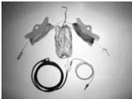
Bild der Antenne im aufgerollten Zustand. Ich verwendete die selbe Antenne auch im AOEC auf 160 m, dabei allerdings als Vertikal gegen Erde.
