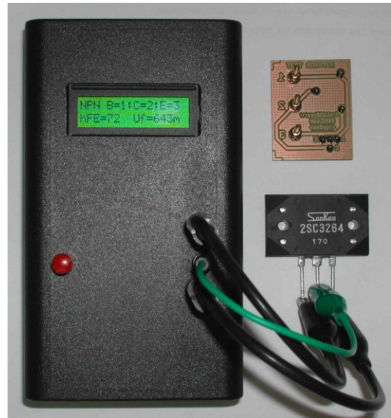
Abb. 1: Fertiger Tester mit Prüfling und SMD-Adapter
