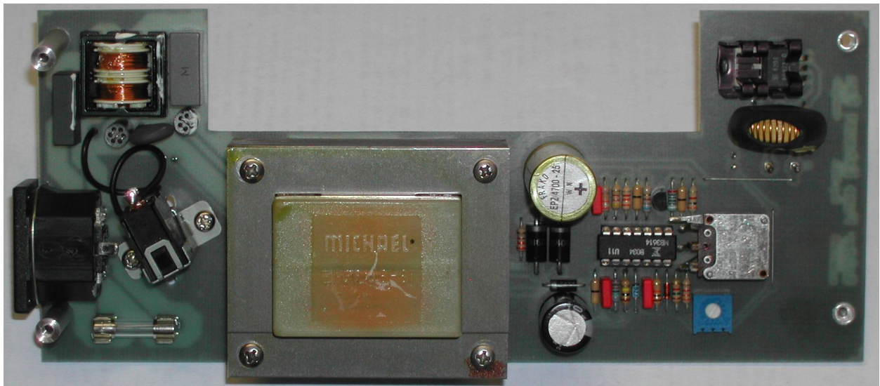
Abb. 7: Bestückte Leiterplatte des Versuchsmusters, Schutzleiter ist noch nicht angeschlossen
