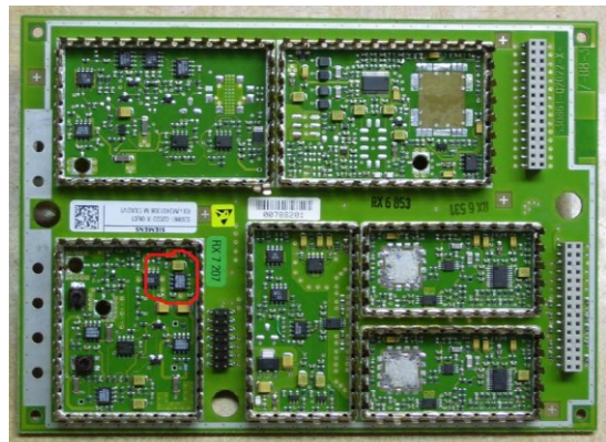
Abb. 7: Die SIEMENS-Baugruppe mit dem AD8307
