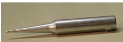
Abb. 5: Die verwendete Lötspitze
