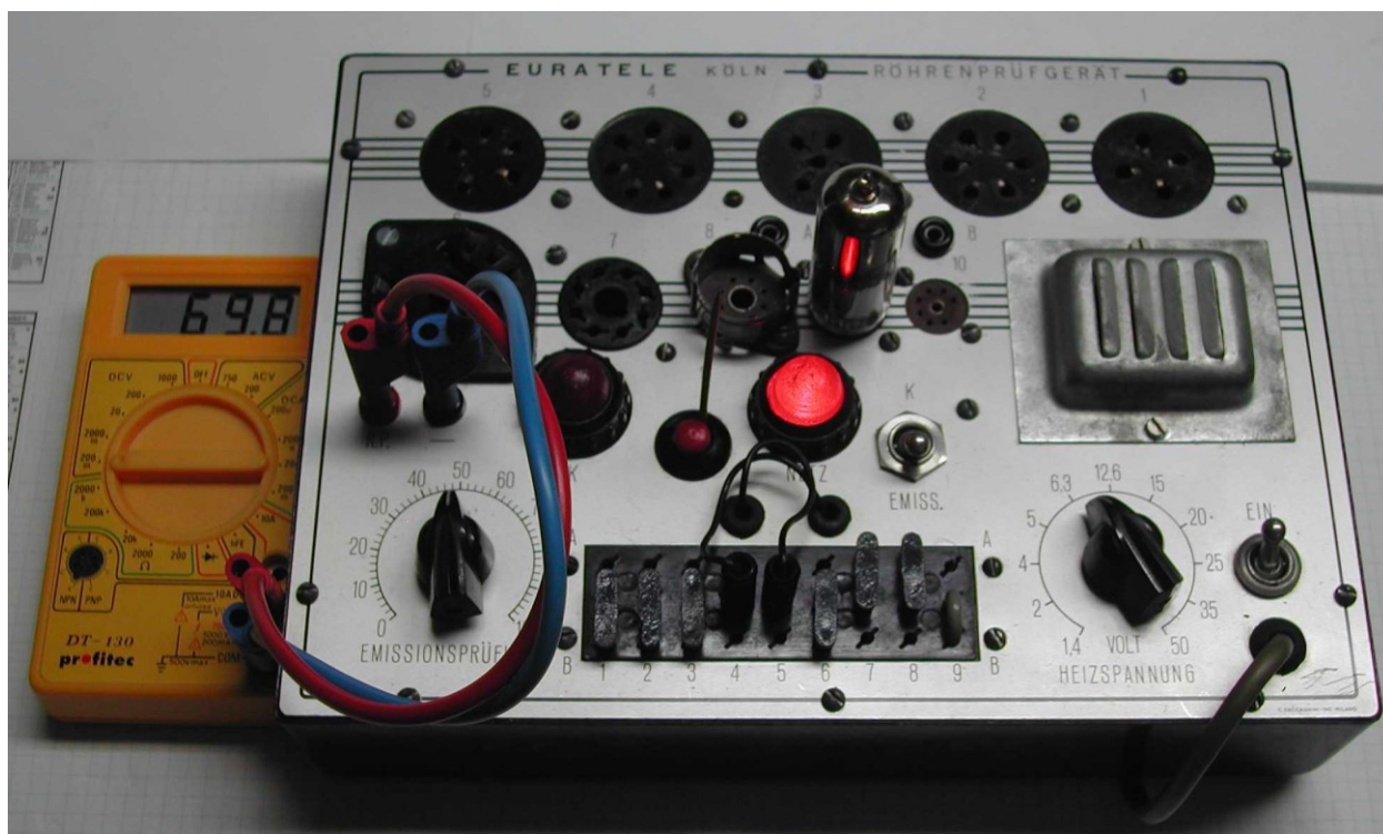
Abb. 5: Neu belebtes Röhrenmeßgerät, Prüfung einer gebrauchten EF80
