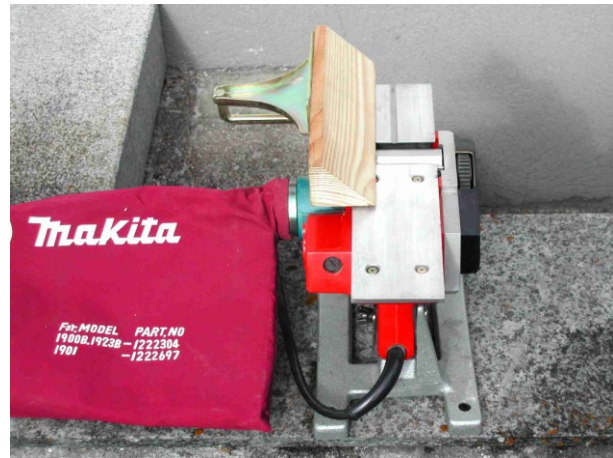
Abb. 8: Zum Kantenbrechen vorbereiteter Hobel
