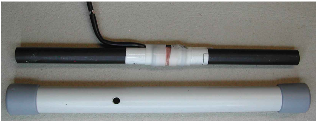
Abb.4: Ferritantenne fertig zum Einbau in das Schutzrohr
