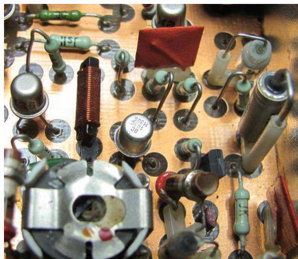
Dieser Transistor wurde dann von mir durch einen „BC109C“ ersetzt. Somit war ab diesem Zeitpunkt eine Anzeige auch im Messbereich I vorhanden.
