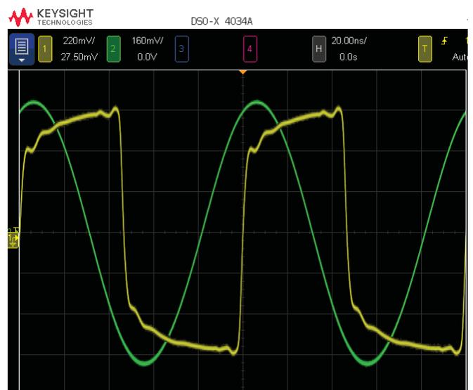
Zwei 10 MHz-Signale im Vergleich: Die gelbe Kurve stammt von einem GPDSO (GPS Disziplinierter Oszillator), einem mittels GPS synchronisierten Referenzsignal. Die grüne Kurve stammt vom Morion MV89. Wenn sich die grüne Kurve gegenüber der getriggerten gelben Kurve seitlich bewegt, ist eine Frequenzabweichung vorhanden. Bei 10 MHz ist auf diese Weise ein Abgleich (Stillstand der grünen Kurve einstellen) bis auf ca. +/- 5 milli-Hz sehr einfach möglich.
