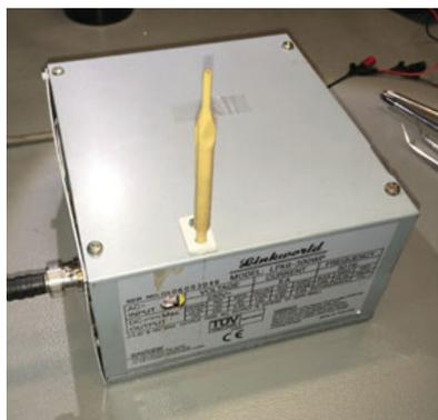
So sieht der komplettierte OCXO aus: Ein Gehäuse zum Nulltarif, von einem PC-Netzteil stammend, schien mir persönlich ausreichend. Der Abgleichschraubendreher wird durch ein Röhrchen ins Innere zum Zehngang-Spindeltrimmer geführt.
