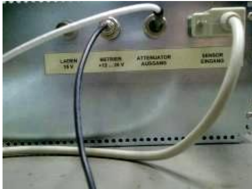
Rückwand (Laden – Betrieb – Ausgang – Sensor)
