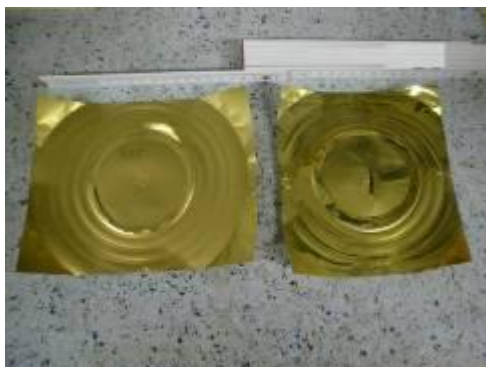
Gerissene Ms-Folie (kurz vor der Verschrottung)
