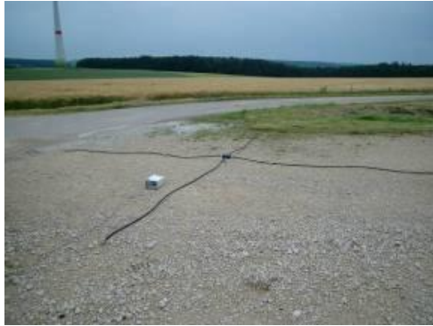
Messaufbau mit Drucksammler
