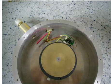
Topf mit Kondensatorplatte und Kalibrator
