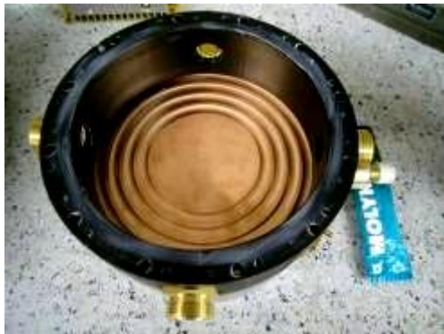
Oberer Topf mit aufgetragenem Abdichtmittel
