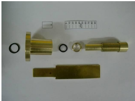
Kalibrator Einzelteile (mit Schlitzmutternschlüssel)
