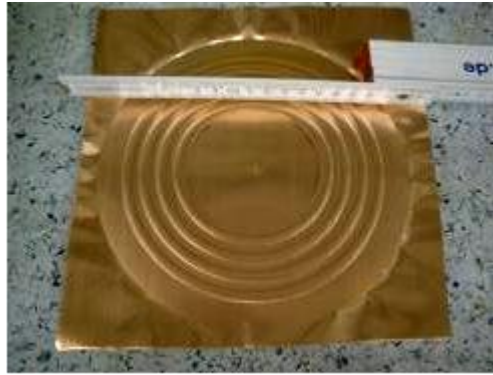
Cu-Membran nach Prägung
