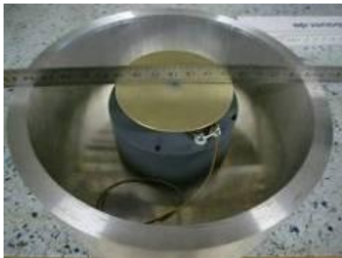
Unterer Topf mit Kondensatorplatte
