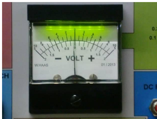
Drehspulmesswerk mit Beleuchtung
