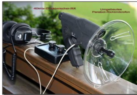
Bild8 Ultraschallempfänger mit Parabolreflektor
