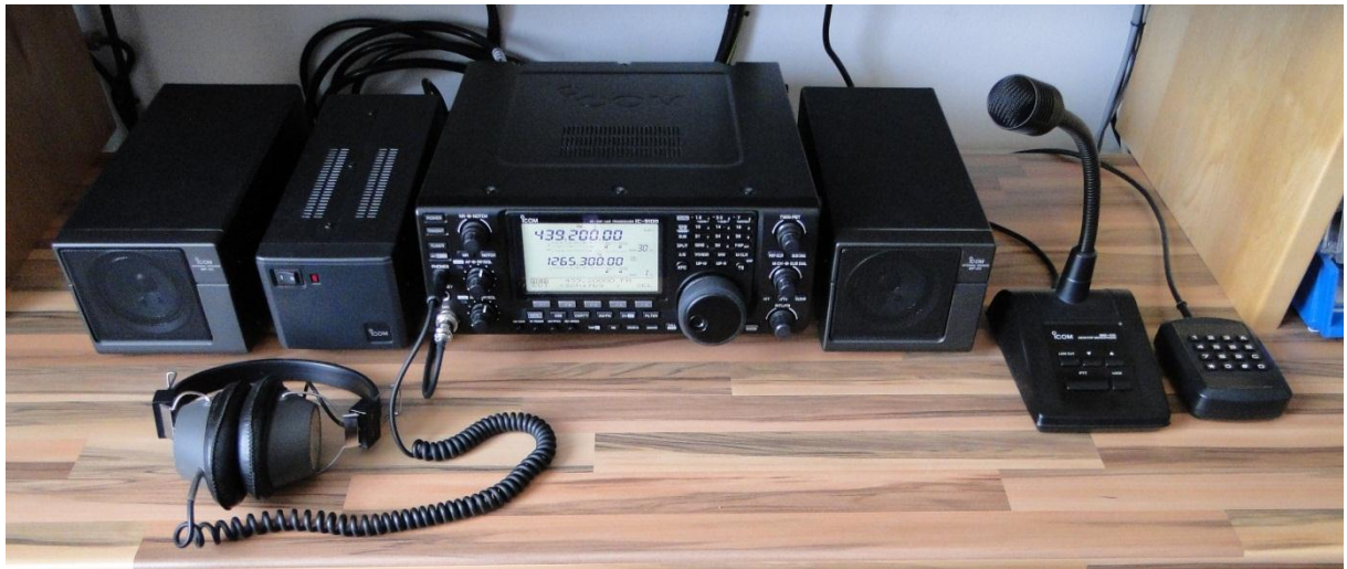
Abbildung 4: DTMF Generator im Betrieb
