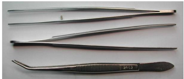
Abb. 2: Pinzetten für die Arbeit mit SMDs
