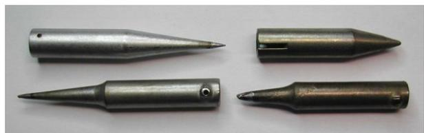
Abb. 3: Eine Auswahl von Lötspitzen für SMD-Arbeiten
