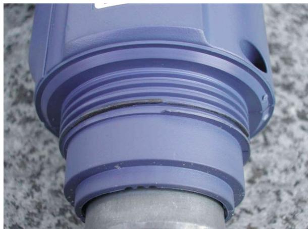
Abb. 2: Das verklebte Gewinde
