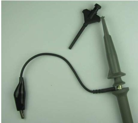
Diese Klemmen sind so klein, dass man damit ein einzelnes IC-Beinchen „mittendrin“ anklemmen kann, ohne dass die benachbarten Beinchen berührt werden. Dies gilt aber nicht für den eigentlichen Anklemm-Vorgang. Dabei sollte unter Umständen die Stromversorgung des Gerätes abgeschaltet sein, da ungewöhnliche Kurzschlüsse ungewöhnliche Auswirkungen haben können.
