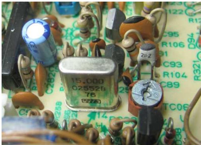
Bei den Quarzen X2001 bis X2004 war zum Teil eine komplette Entfernung des fixen Serienkondensators nötig, um auf die richtige Frequenz zu kommen.
