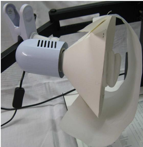
Da diese Lampenfassungen aber einen sehr kleinen (ca. 8 cm Durchmesser) Reflektor besaßen, wurden diese mittels einer Bleischere abgeschnitten und größere mit ca. 16 cm Durchmesser aus weißem Karton angebracht.
