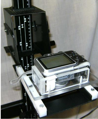
Somit konnte man nun die Kamera bis über 80 cm über der Grundplatte vertikal per Kurbel einstellen. Für den gewünschten Zweck eine optimale Lösung. Bei den Versuchen hatte sich nämlich herausgestellt, dass diese Höhe durchaus noch sinnvoll ist. Im praktischen Betrieb wird nun mit dem Zoom der Kamera grob eingestellt, die Feineinstellung erfolgt dann mit der Kurbel für die Höhenverstellung.
