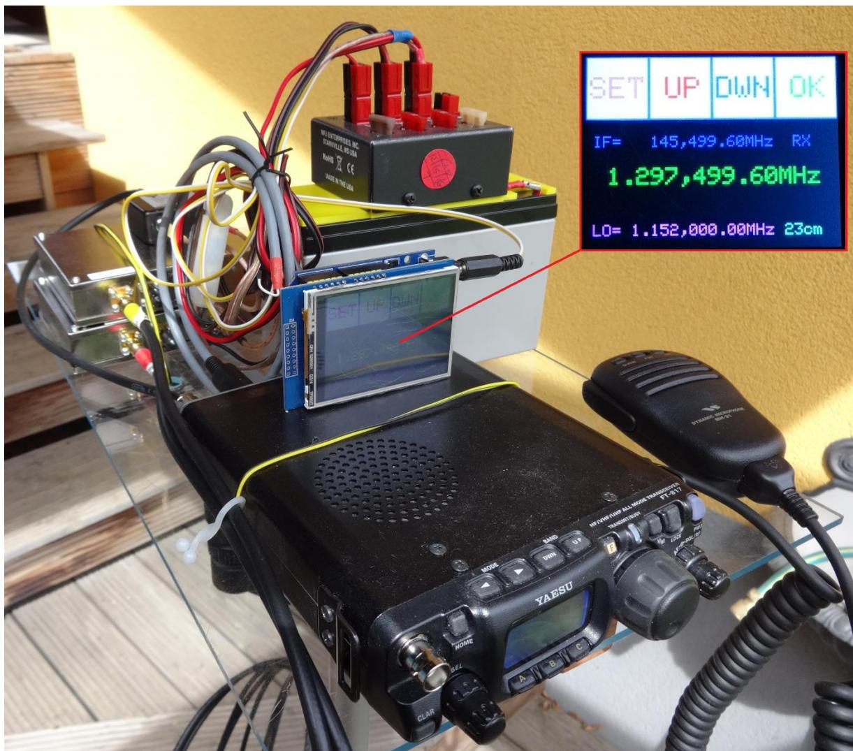
Bild oben: Der Display-Prototyp ohne Gehäuse am FT-817ND
