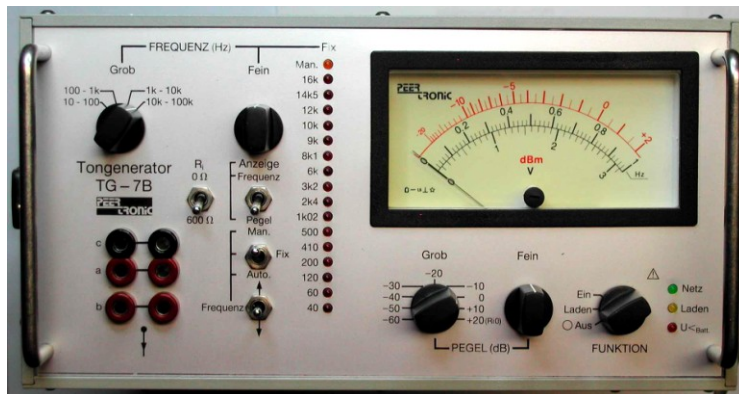
Die Ausgangsspannung ist an den auf der Frontplatte links unten nebeneinander liegenden 2*3 Stück 4-mm-Buchsen zu entnehmen; die beiden senkrechten Reihen sind parallelgeschaltet.
