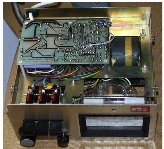
Abb. 2: Unterseite des umgebauten HAM-II
