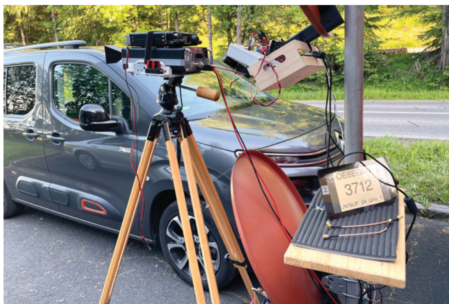
24 GHz DATV-Empfang mit Transverter über 95 km. Bei dieser Station wurde als Antenne nur das kleine Horn, vorne am Transverter, verwendet.
