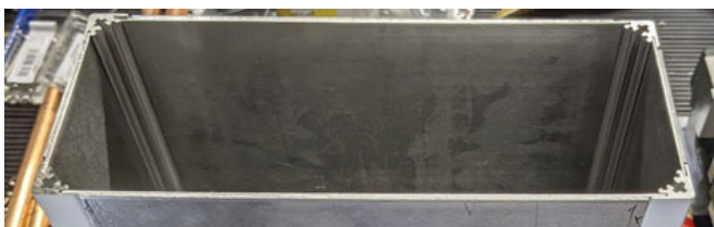
Abb. 5: Alu Eck-Profil mit Seiten und Boden/Deckel Blech
