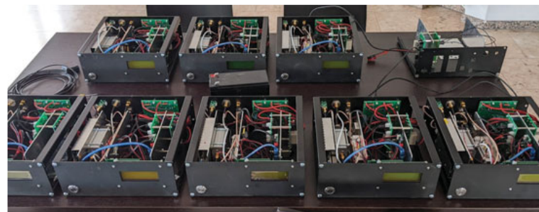
Abb. 7: Transceiver warten auf die Tests nach dem Zusammenbau
