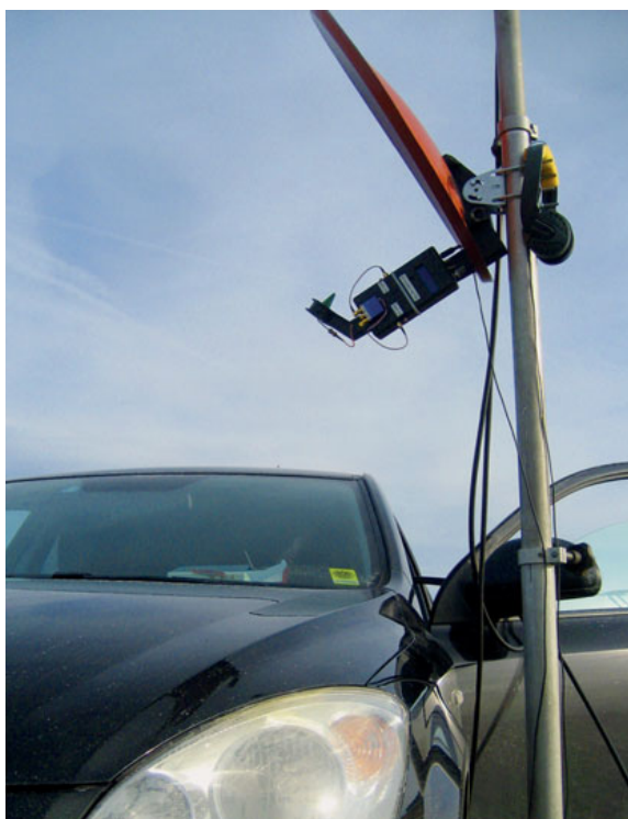
3cm QRP-Station von OE8FNK/P in Lichtenegg im Dez. 2019. Ein Milliwatt und ein 60cm-Spiegel reichen für die Sichtverbindungen.
