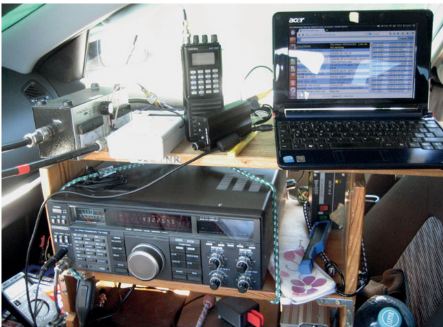
Funkstation am Beifahrersitz, ganz oben 13cm El Cuatro und der Receiver für 13cm, der Memory-Keyer und der Laptop für den ON4KST-Chat. In der Mitte der TS-790e Transceiver, unten die Morsetaste und die PAs für 70cm und 23cm.
