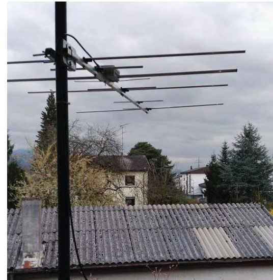
oben, Abbildung 2: 9 Element Duoband-Yagi in Richtung OE9XVI-10, mit den „drei Tannen“ in Funkrichtung
