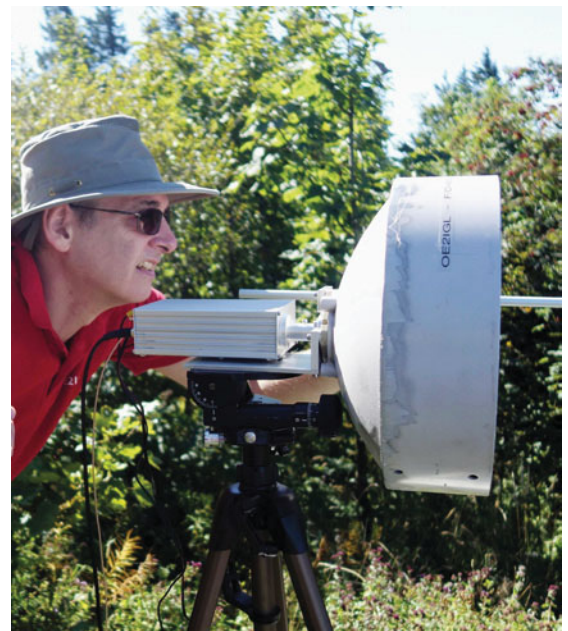
Gerald OE2IGL beim optischen Ausrichten seiner 30 cm Antenne (Foto OE5LJM)
