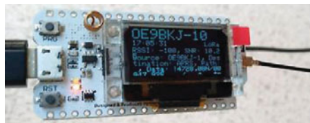
Abbildung 1: TTGO T-Beam V1.0 bei der Stromaufnahme-Messung im „WX fixed“ Mode mit Standard 433 MHz Stummelantenne aus Lieferumfang.
