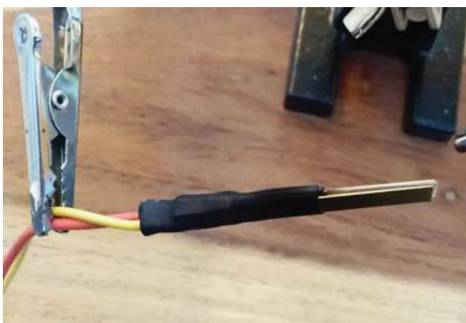
Abbildung 5: Strommessvorrichtung mit zwei voneinander isolierten Blechen
