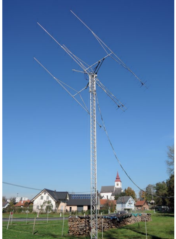
4x17-Element Cushcraft 17B2, 5 Lambda Länge, auf 12 Meter Alu-Mast
