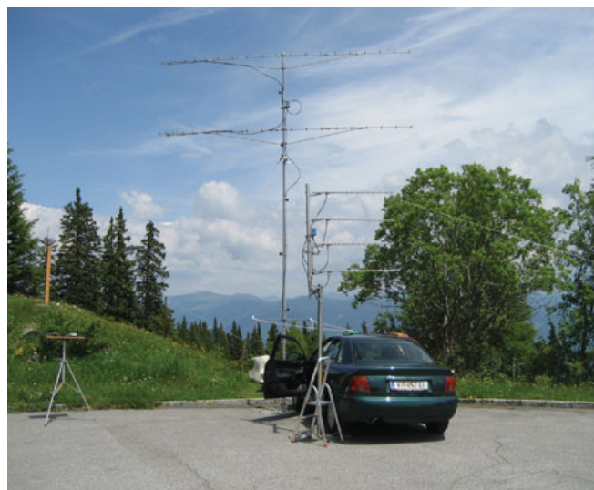
OE8FNK im Alpe-Adria UHF Kontest 2018, 2x21el Yagi für 70cm und 4x16el für 23cm waren im Einsatz.
