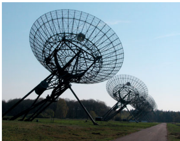
unten: die neue Antennenanlage von Astron besteht aus 14 25m-Parabolantennen, die gekoppelt werden können.
